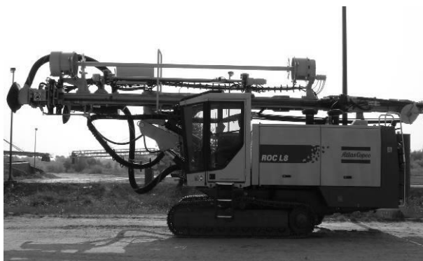
Slika3: Udarno rotaciona bušača garnitura
