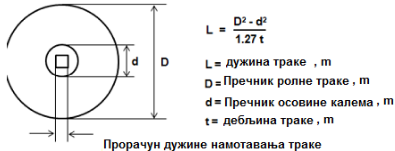
Слика 8.2. Прорачун дужине намотавања траке на калеме/ролне
