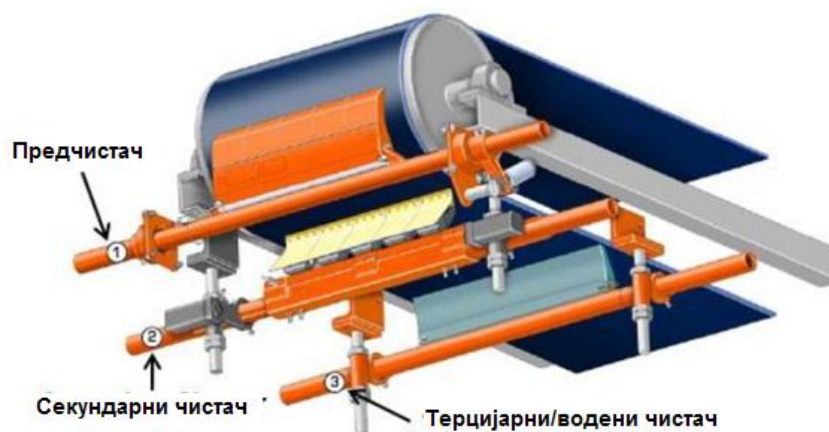
Слика 3.20.а. Систем вишестепеног чишћења
