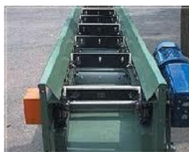
Слика 2.11.: Чланкасти и плочасти транспортери различите конструкције
